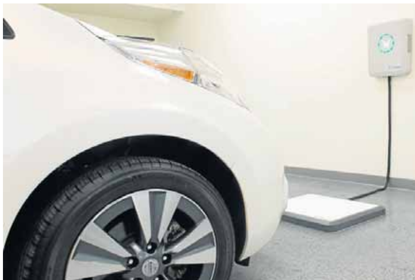
La implantación de los sistemas de carga inalámbrica de los automóviles eléctricos empezará por los garajes antes de trasladarse a las vías públicas, en las que el dispositivo cargador deberá ser empotrado bajo el asfalto.
